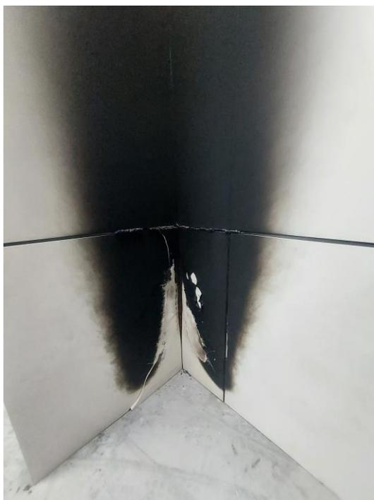
Apparence de l'échantillon avant et après l'essai SBI (aile courte et aile longue)
